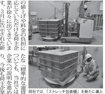
同社では、「ストレッチ包装機」を新たに導入し、荷崩れを防ぐためのストレッチフィルムによる包装を自動で行うことができる
