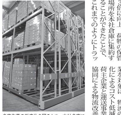
倉庫作業の効率化を図るため、本社倉庫に大型自動移動棚を2基導入した
